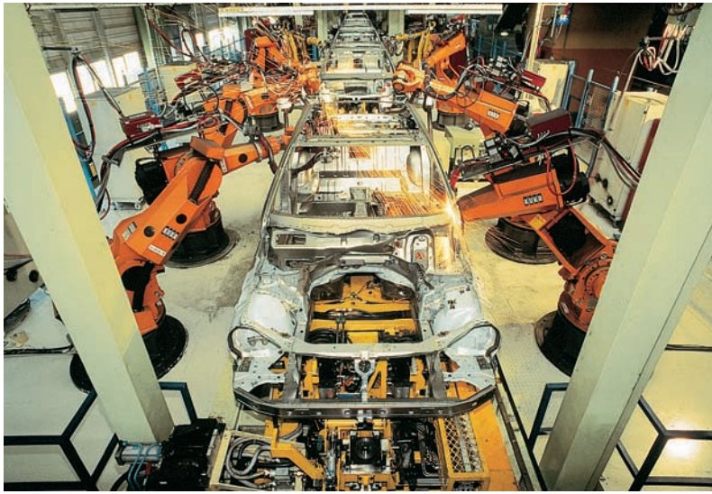
Automatisierung. Der Einsatz von Industrierobotern in der Automobilproduktion
